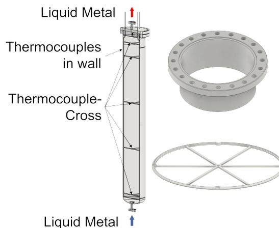
Abbildung 1: CAD-Zeichnung der Messstrecke und einzelner Bauteile
